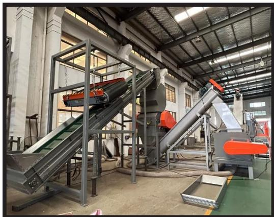
*Imagen 1: Banda delantera y molino de cuchillas*
