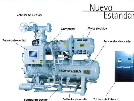
UNIDAD DE COMPRESOR TORNILLO PARA REFRIGERACIÓN
