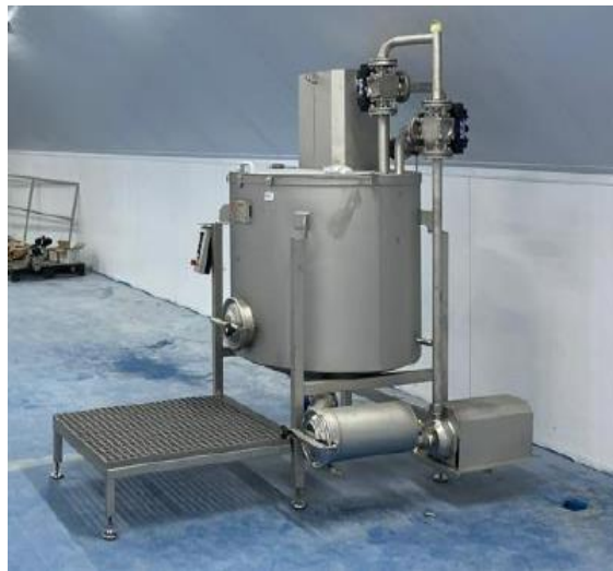
Tanque de aditivos
