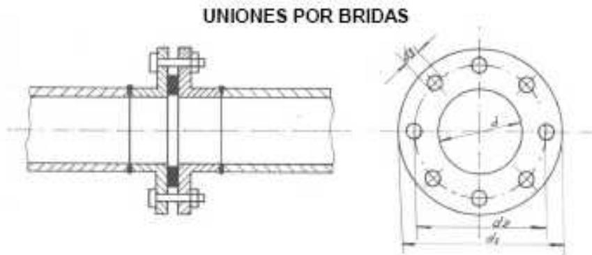
a) Las juntas o empaquetaduras utilizadas para retener el gas deben ser resistentes a la acción de este y deben estar hechas de metal o de otro material adecuado confinado en metal que posea un punto de fusión mayor que 816°C ó deben hallarse protegidas de la exposición al fuego.
