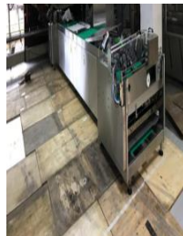
Fig.6 Mesa de Acumulación Horizontal, 1002
