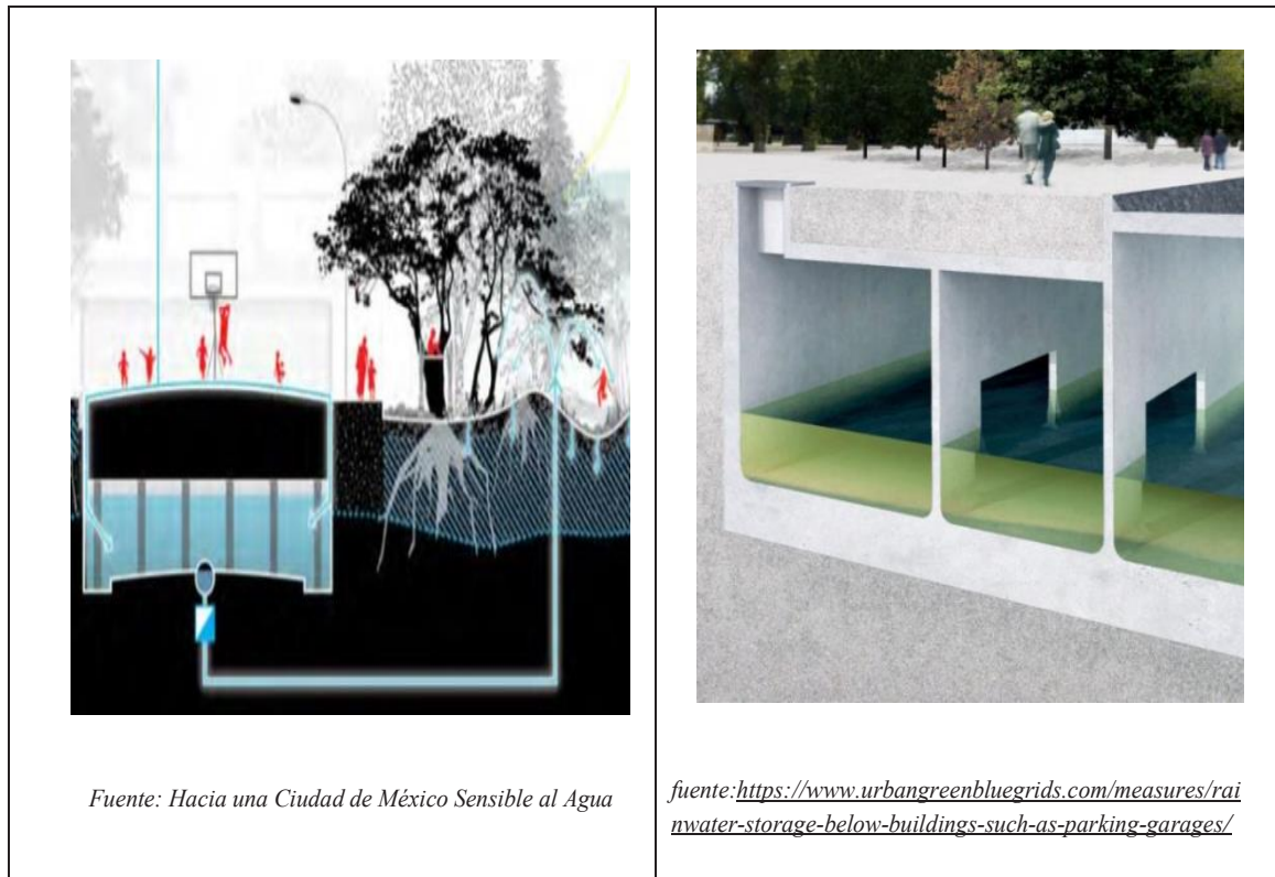
Figura 2.35. Cisternas de agua lluvia para retener, almacenar y reutilizar el agua para riego en época seca
