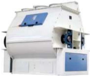
Imagen 3. Mezcladora de doble eje horizontal
