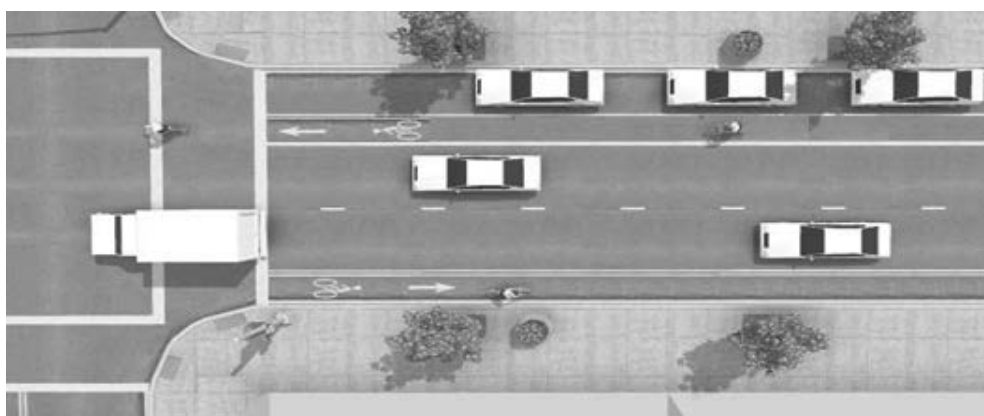
Ejemplo señalización carril bicicleta contra flujo Fuente: NACTO
