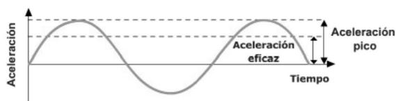
Al igual que otras medidas de aceleración, indica cómo varía la velocidad de un elemento en movimiento con el tiempo.
