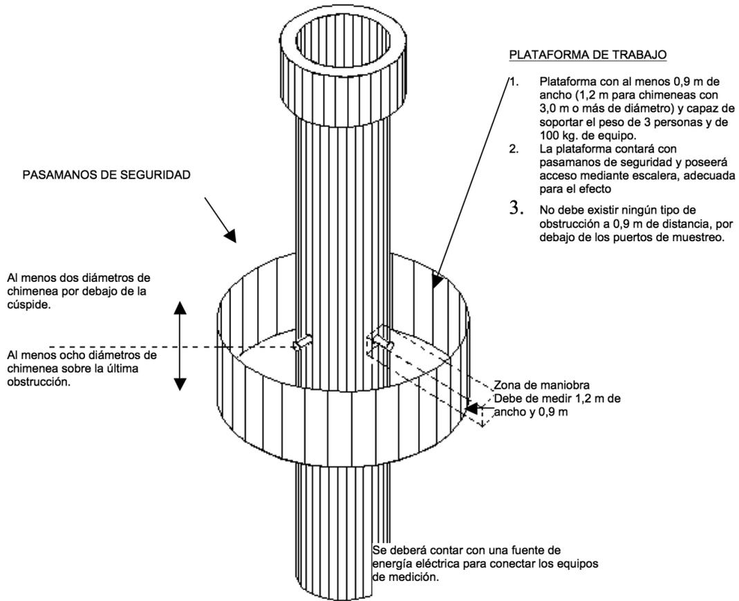
FIGURA 2. NÚMERO DE PUNTOS DE MEDICIÓN DE EMISIONES AL AIRE DESDE FUENTES FIJAS
