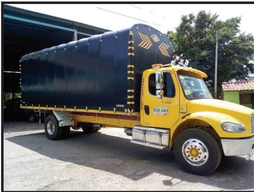
**Fig. Nro. 6:** Uso de lona de PVC como carpa para camiones; Marca: Plastextil; Modelo: SUIZA Z
