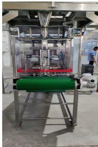
Foto 6. Máquina de llenado/sellado vertical PK-70L MHW
