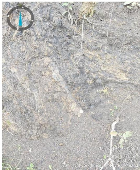
Fotografía.1. Afloramiento identificado en las coordenadas (725194 E, 974569 N), con presencia de lutitas altamente fisuradas con buzamiento al oeste - suroeste, fácilmente deleznable. Fuente: SGR CZ3.
