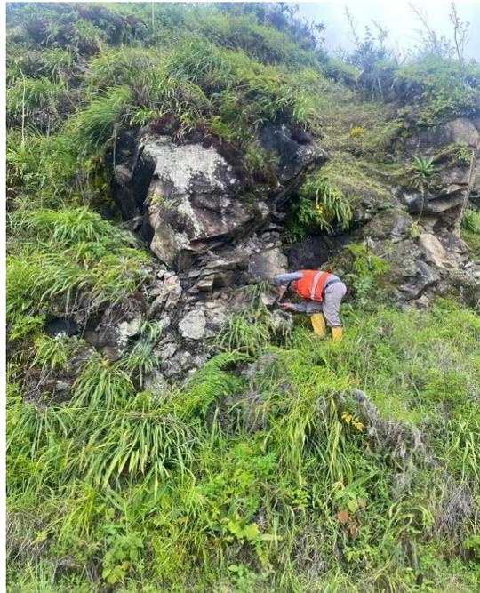
Fotografía.2. Afloramiento identificado en las coordenadas (724643 E, 9745380 N), se identifica afloramientos de roca andesítica porfídica de color gris verdoso con considerable fracturamiento. Fuente: SGR CZ3.
