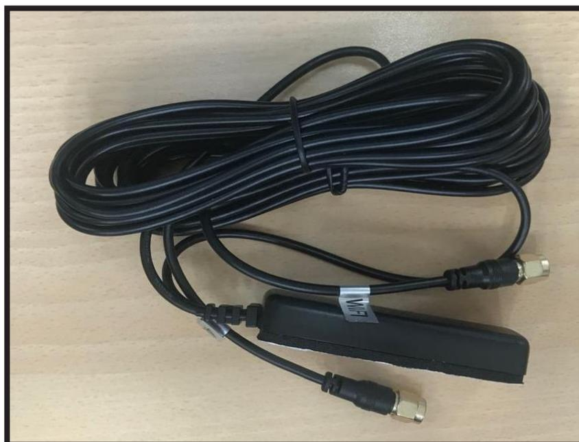
*Fig. Nro. 7: Antena Wi-Fi - 4G (Wi-Fi - 4G Antenna)*
