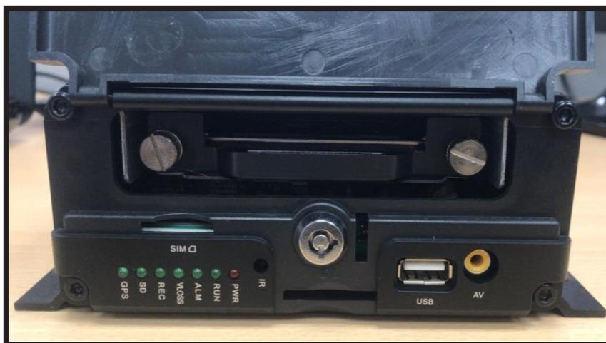
*Fig. Nro. 4:* MDVR (Mobile Digital Video Recorder) con panel frontal abierto; Marca: LSZ; Modelo: LSZ-B6804HG-Q-F
