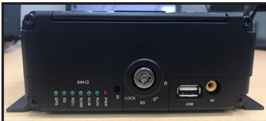
*Fig. Nro. 3:* MDVR (Mobile Digital Video Recorder) con panel frontal cerrado; Marca: LSZ; Modelo: LSZ-B6804HG-Q-F
