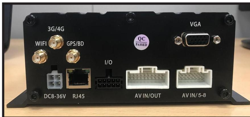
*Fig. Nro. 5:* Vista posterior del MDVR (Mobile Digital Video Recorder); Marca: LSZ; Modelo: LSZ-B6804HG-Q-F
