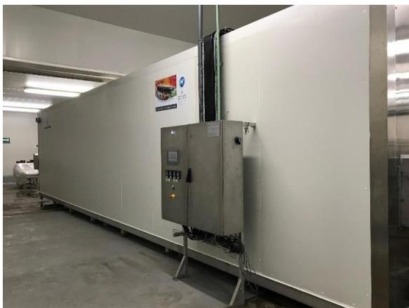
Imagen 3: Túnel de secado de aire forzado
