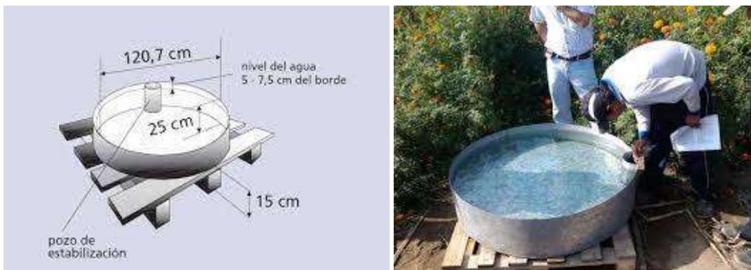
Ilustración 4. Tanque de evaporación Clase "A"
