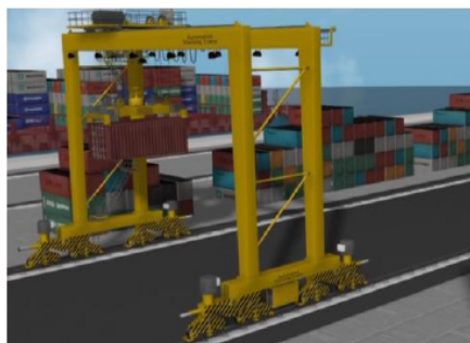
Imagen de referencia, deja ver trabajo realizado por una grúa pórtico la cual se mueve por un "sistema de rieles de rodadura fijadas al suelo".
