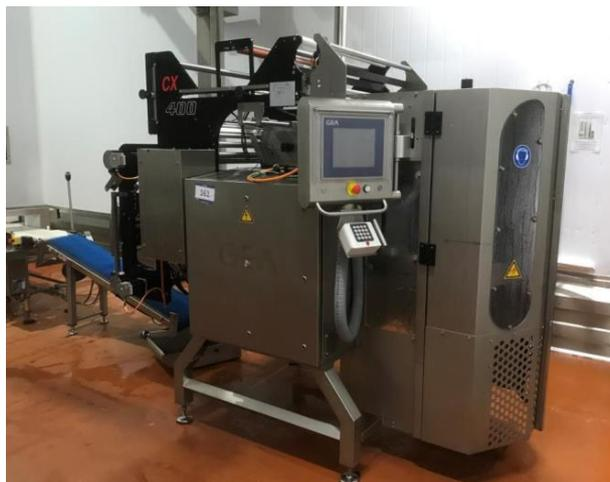
Imagen 2. Máquina empaquetadora/selladora
