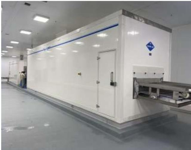
Imagen 2. Túnel de congelación rápida lineal (IQF)
