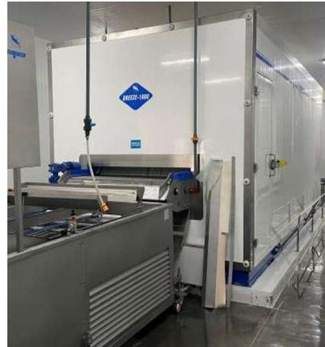
Imagen 3. Túnel de secado por aire forzado
