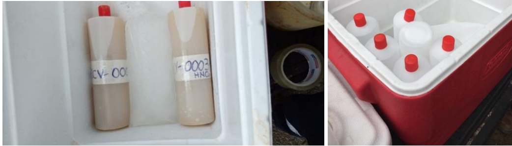
Fotografía 3. Codificación y almacenamiento de muestras de agua
