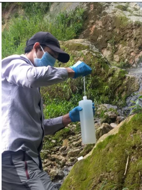
Fotografía 2. Preservación de muestras de agua con HNO 3
