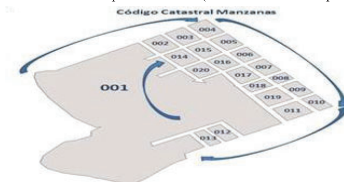
Ilustración 3: Codificación catastral para manzanas (sentido horario en espiral)
