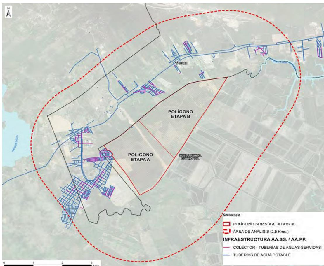
Ilustración 26 Redes de agua potable y aguas servidas en el área de diagnóstico
