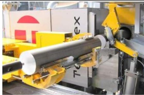
Imagen 2. Cizalla con accionamiento hidráulico
