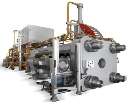
Imagen 3. Prensa de extrusión de aluminio
