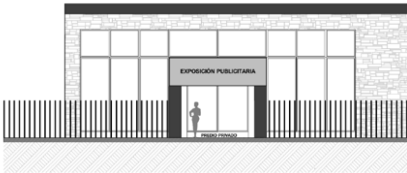
Figura. 18.- Tipo C – Pórtico. - Publicidad o propaganda exterior en predios privados, edificados o en proceso de edificación, emplazados en el cerramiento de entradas y salidas del predio.
