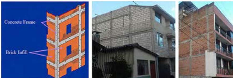
Figura 119: Tipo de sistema estructural: Pórticos de hormigón armado con mampostería confinada sin refuerzo (C3).
