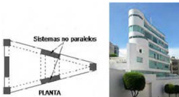
Figura 139: Irregularidad en planta: ejes estructurales no paralelos
