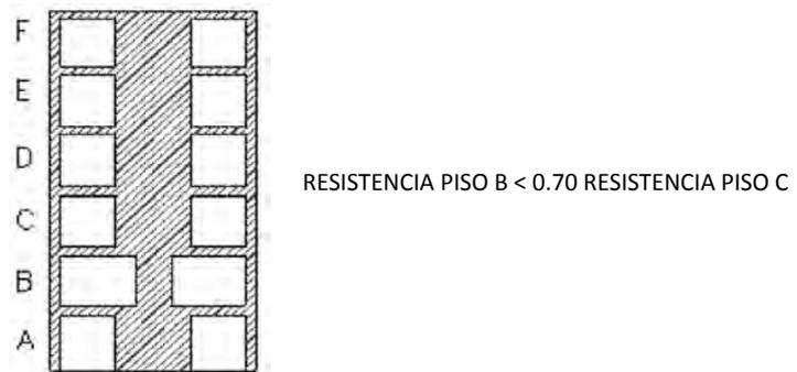
Figura 20: **Discontinuidad en la resistencia**
