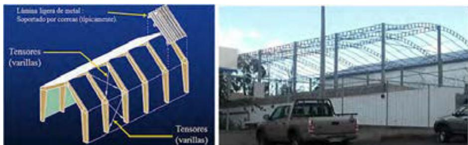
Figura 123: **Tipo de sistema estructural: Pórtico de acero doblado en frío (S3).**
