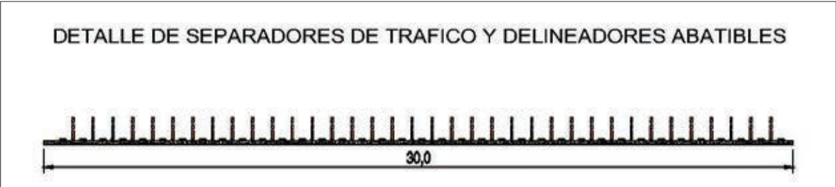
Figura 35 separadores de tráfico y delineadores abatibles frente al acceso del edificio.
