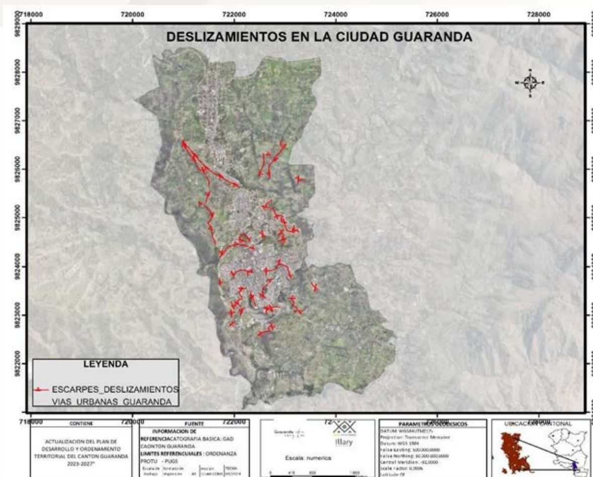
Mapa N° 39: Deslizamientos en vías en la Ciudad de Guaranda
