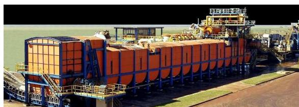
*Imagen del sistema de extracción de sacarosa de caña de azúcar por difusión*
