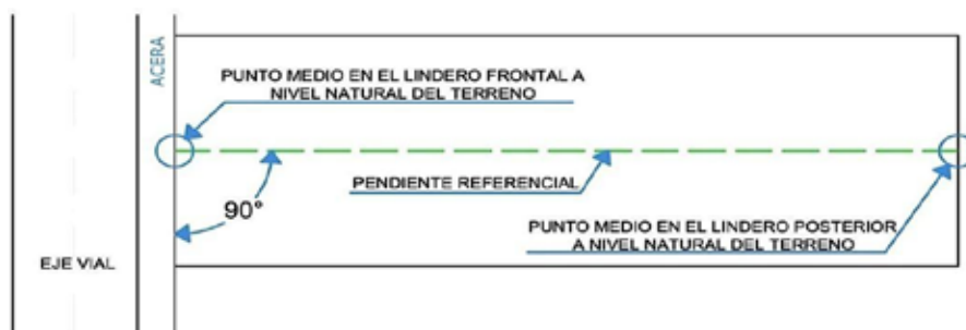
Figura 26. Pendiente referencial en terrenos regulares
