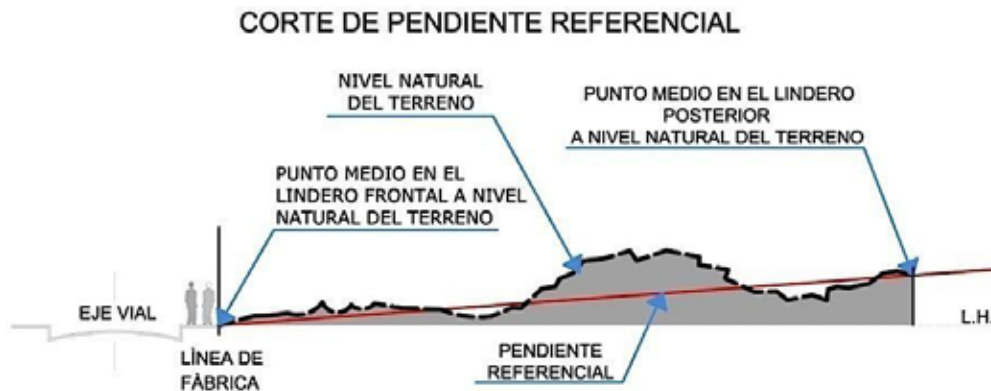
Figura 29. Corte de pendiente referencial.
