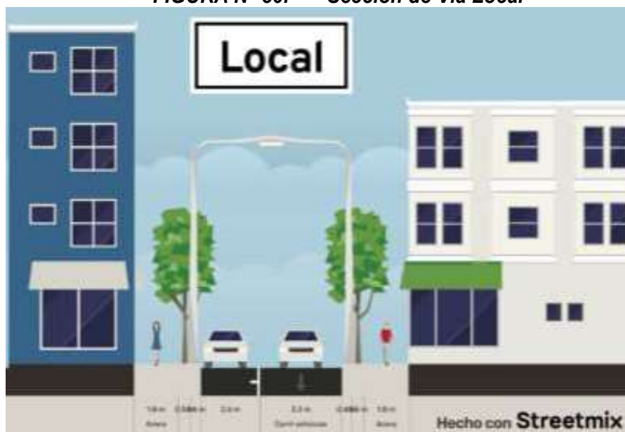
FIGURA N° 30.- Sección de Vía Local
