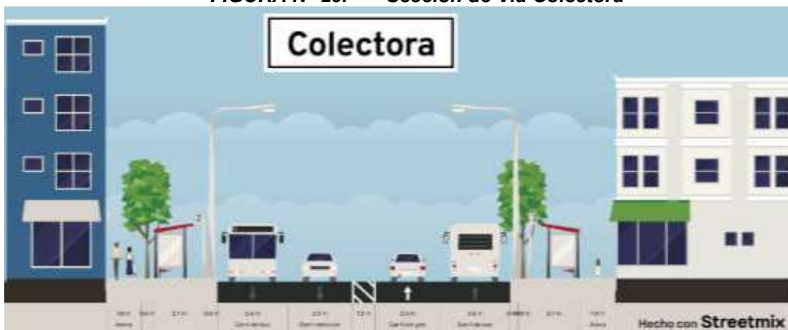
FIGURA N° 29.- Sección de Vía Colectora
