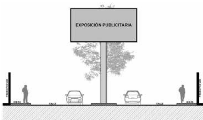
Figura. 1. Tipo A – Alta.- Publicidad o propaganda exterior en mediana o banda central (parterre).
