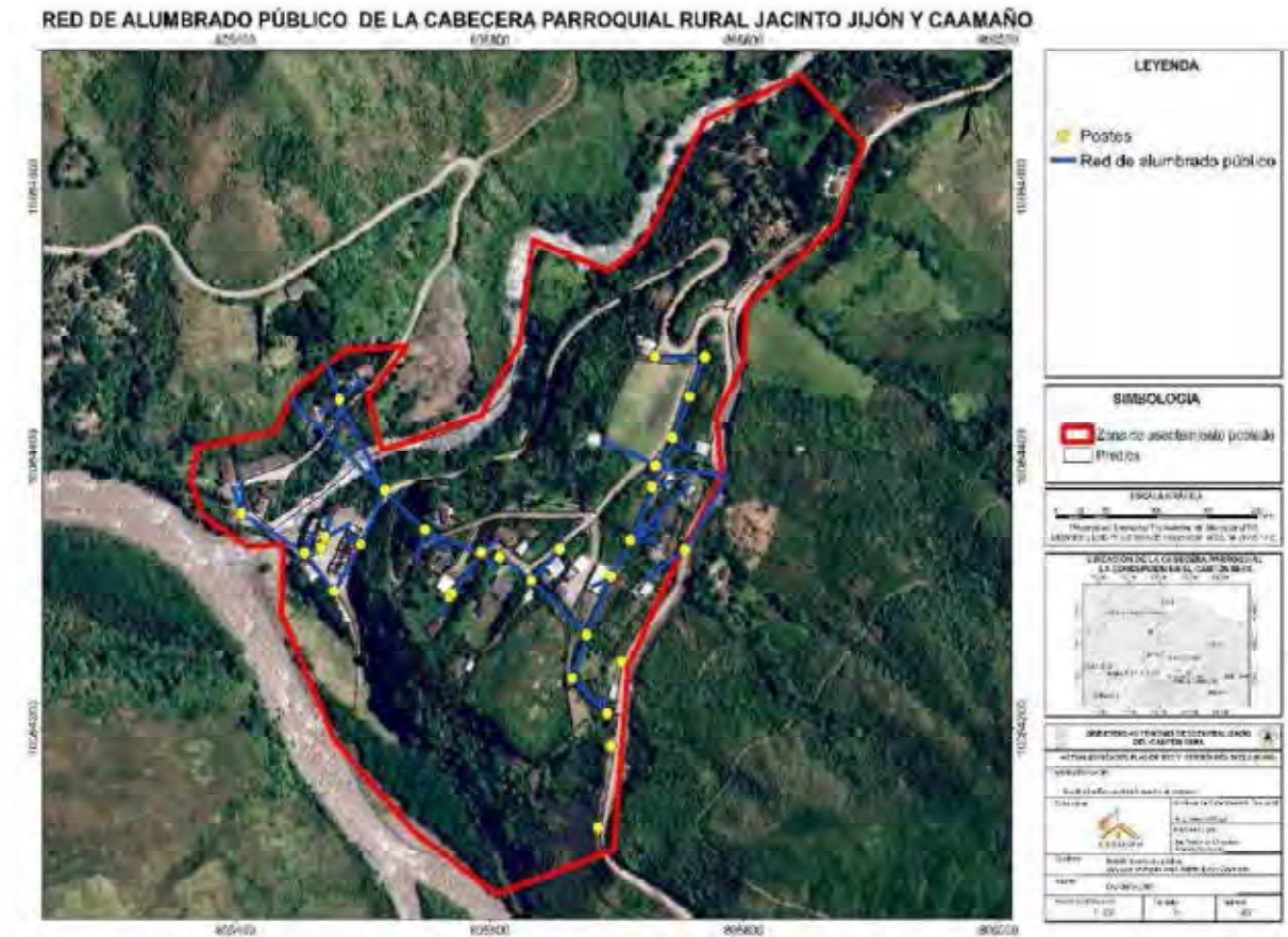
Mapa 26. Red de alumbrado público de la cabecera parroquial rural Jacinto Jijón y Caamaño
