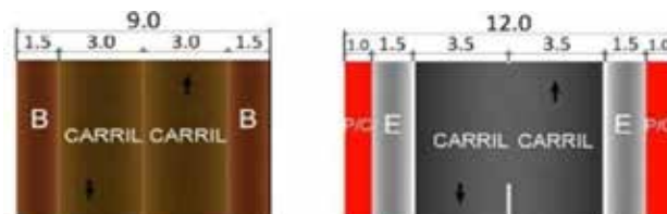
Ilustración 61 Sección transversal de vías básica y convencional Fuente: NEVI-12, 2013 – MTOP
