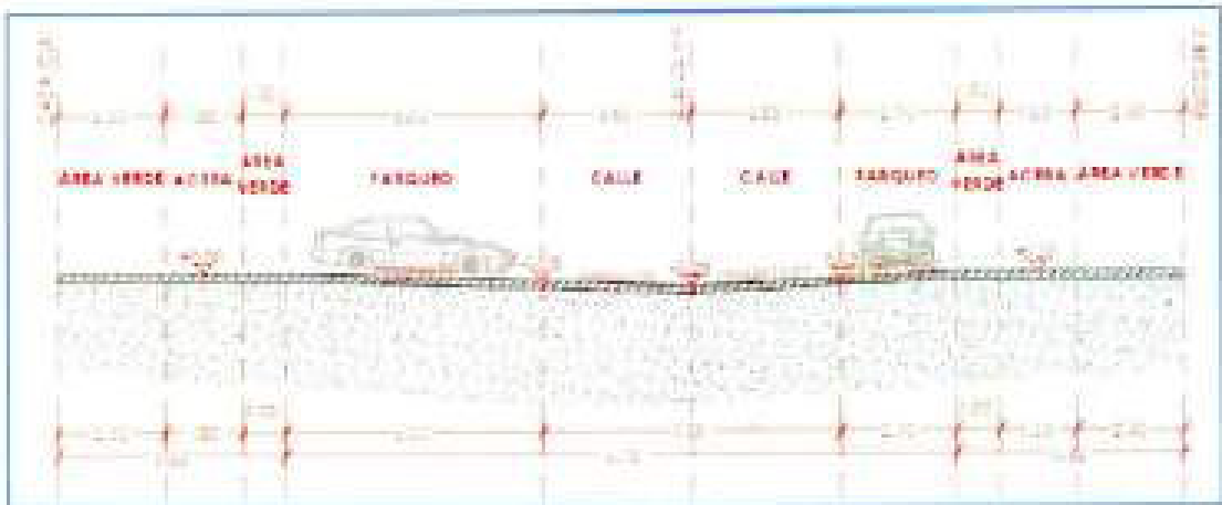
Imagen 10.- Sección de Via Tipo C Fuente: EIV
